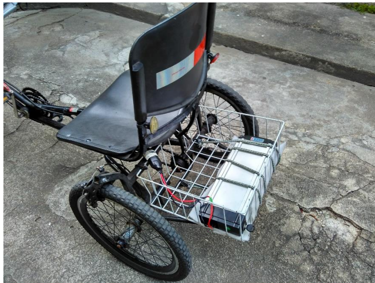
Figura 3: Bateria montada na cesta traseira
